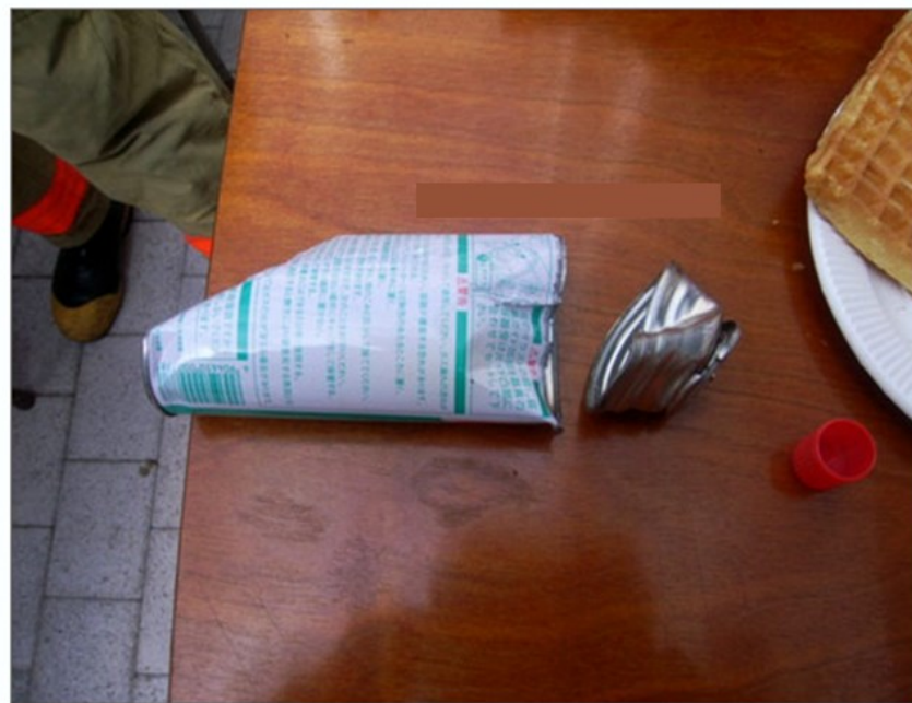
写真2：破裂したカセットボンベ
